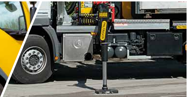
Abstützung und hochschwenkbare Stützen (optional) Arbeiten bei eingeschränkten Platzverhältnissen
